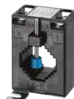
TC, CLASE 1/2.5VA-230V. 200/5A. BUSBAR 30X10/25X15/20X20MM.
