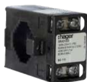
TC, CLASE 1/2.5VA-230V. 100/5A. BUSBAR 30X10/25X15/20X20MM.
