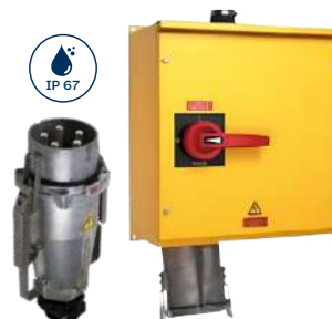
Enchufe aéreo y toma visible con enclavamiento mecánico DUO 400A, 3P + T, 690V, 5H
